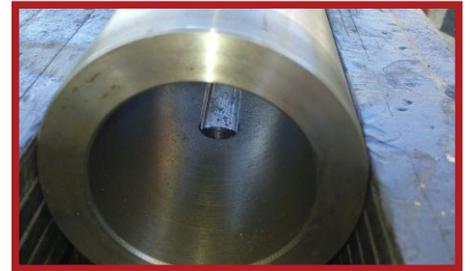
FABRICACIÓN DE COUPLING SHAFT
