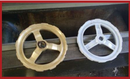
FABRICACIÓN DE VOLANTE PARA VÁLVULA
